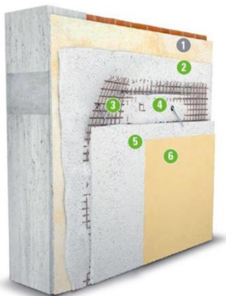
Sistema antiribaltamento tamponature Kerakoll
