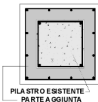
Schema tipo ringrosso dei pilastri
